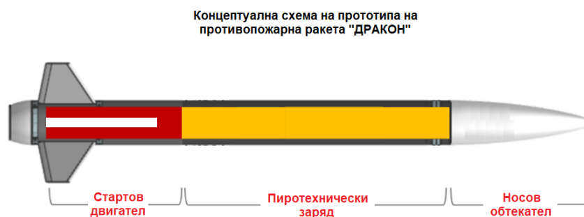
Фиг. 1. Обща блокова схема на противопожарна ракета
